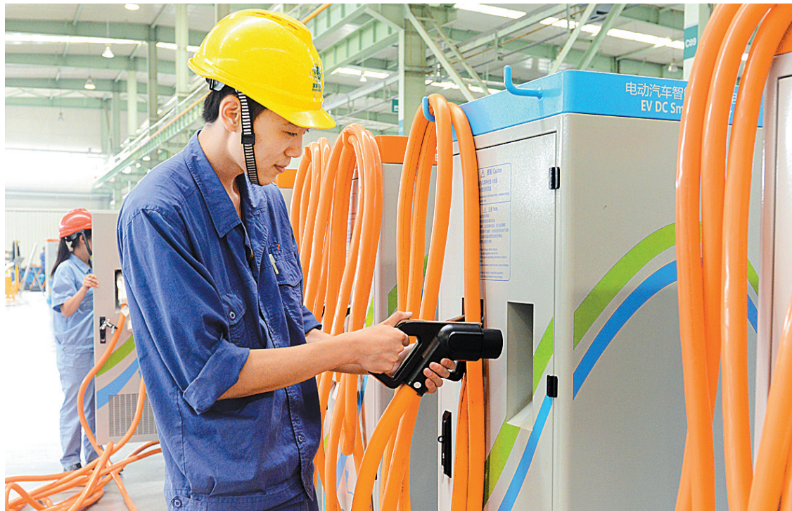
8月23日,技术人员在河南平高通用电气有限公司厂房内检测即将出厂的电动汽车智能充电桩。该公司自主研发的直流充电桩系列产品可通过手机软件实现充电桩的定位、远程控制预约、便捷扫码充电等功能,适用于居民区、停车场、充电站等多种场所,相比同类产品具有体积小、重量轻、输出效率高、防护功能齐全等优点。在前不
