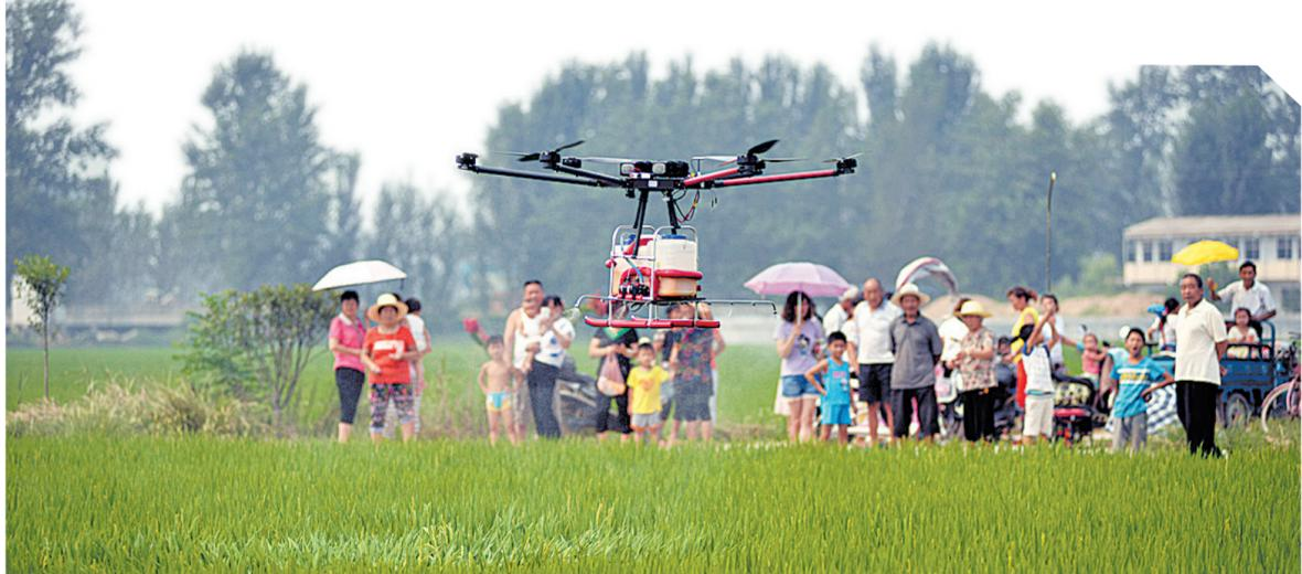
农业植保无人机在稻田里喷洒预防纹枯病的生物制剂
