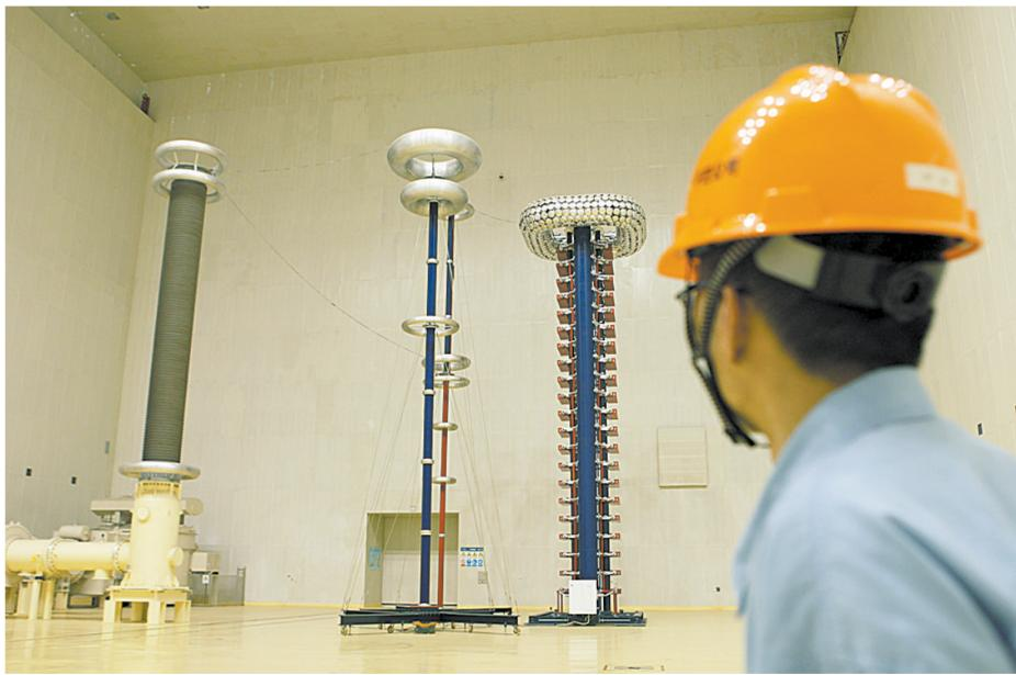
3月11日,职工从雷电发生器下走过。作为国家特高压工程第一批参建单位,平高集团牢牢把握模块化建设这个主题,坚持“安全第一、质量第一、有序推进”原则组织生产。平高集团东区特高压装配厂高压试验大厅里有两台总价值1亿多元的关键设备——工频变压器和雷电发生器,其中,雷电发生器高30多米,是目前世界最大的发生器,它能模拟自然界的雷电冲击,用以检验特高压断路器质量。本报记者 李志勇 摄
