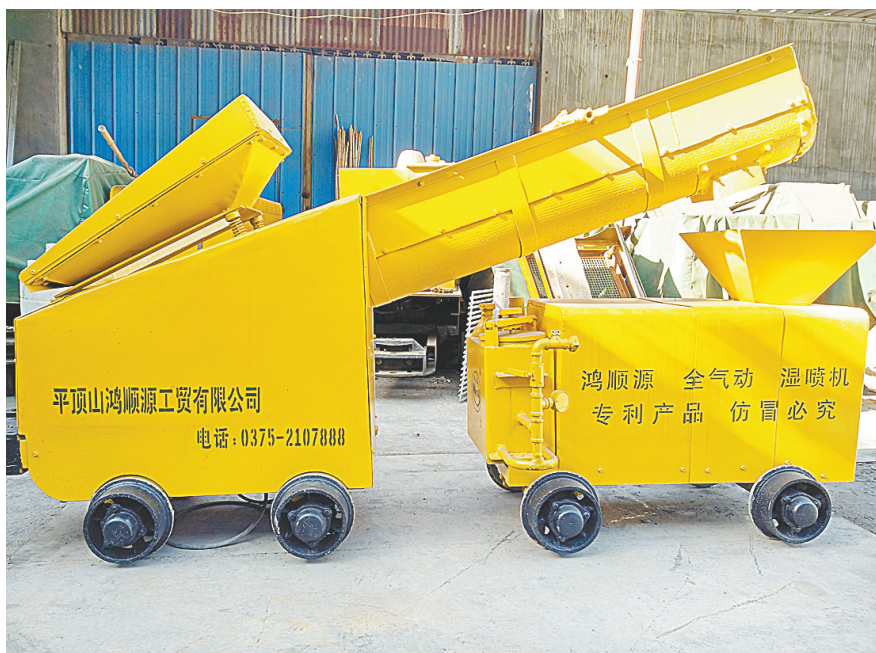
图为平顶山鸿顺源工贸有限公司董事长张发院研发出的全气动湿喷机
