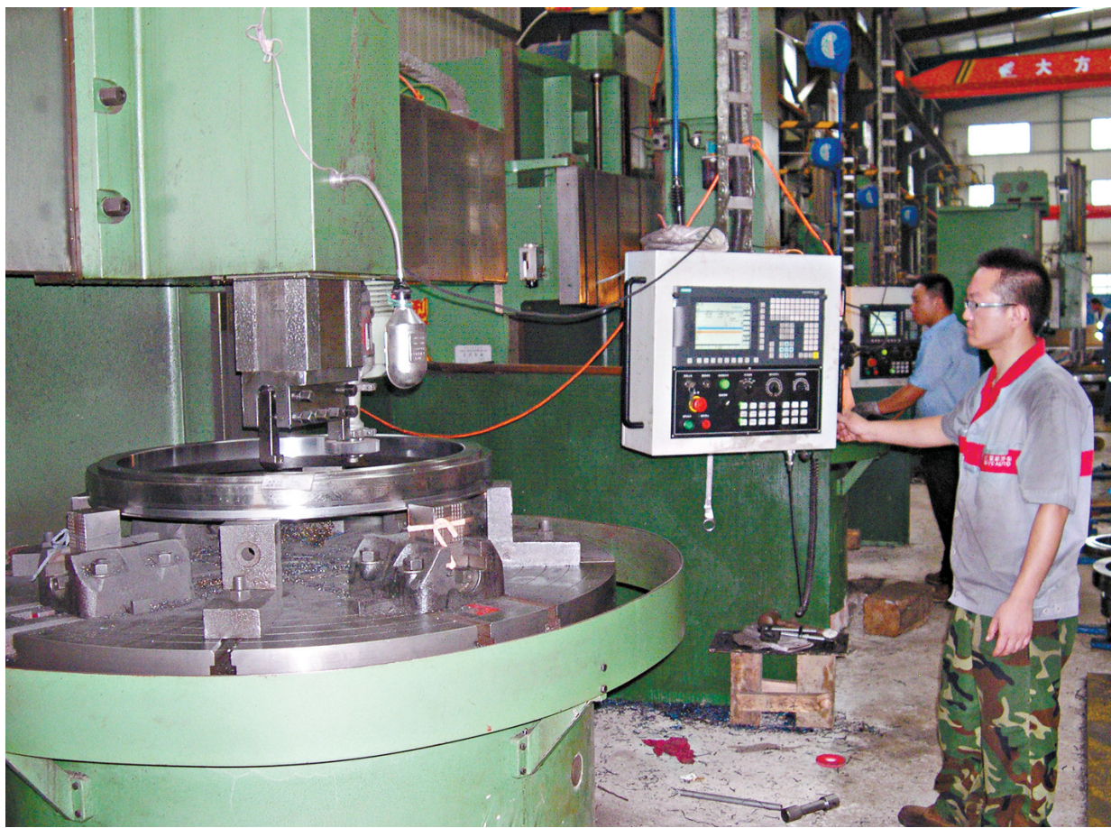
近日,工人在加工生产风电用锁紧盘。 位于舞钢市产业集聚区的中泰重工风力发电设备配套项目,生产风电用锁紧盘等关键零部件,年产量2000台(套),产值5000万元。
