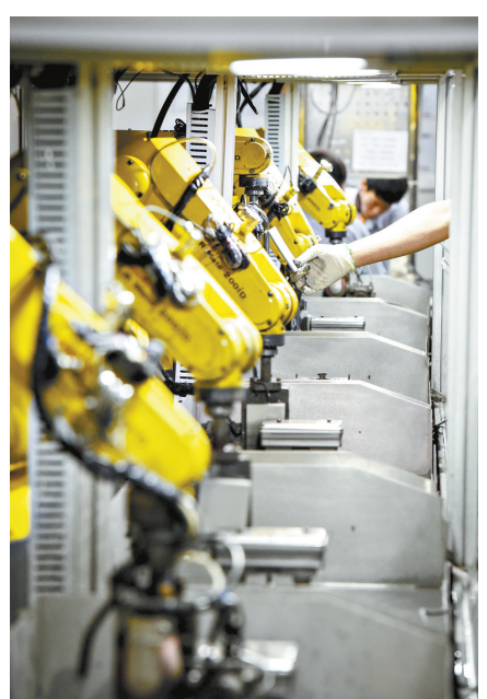
在东莞松山湖长盈精密技术有限公司“无人工厂”打磨车间，一位工人给打磨机械手更换砂纸。该车间在完成“机器换人”改造后，机械手基本替代了人手（5月13日摄）。 事实上，珠三角无疑就是一个最佳的观察平台——在这里，既有华为、中兴、美的、格兰仕这样的跨国级企业，也有众多创新型科技制造企业和传统劳动密集型企业。它们既在努力应对依然持续的全球经济下行压力，也在从不同层面摸索、探寻“中国制造2025”的实践之路。 新华社记者 刘大伟 摄
