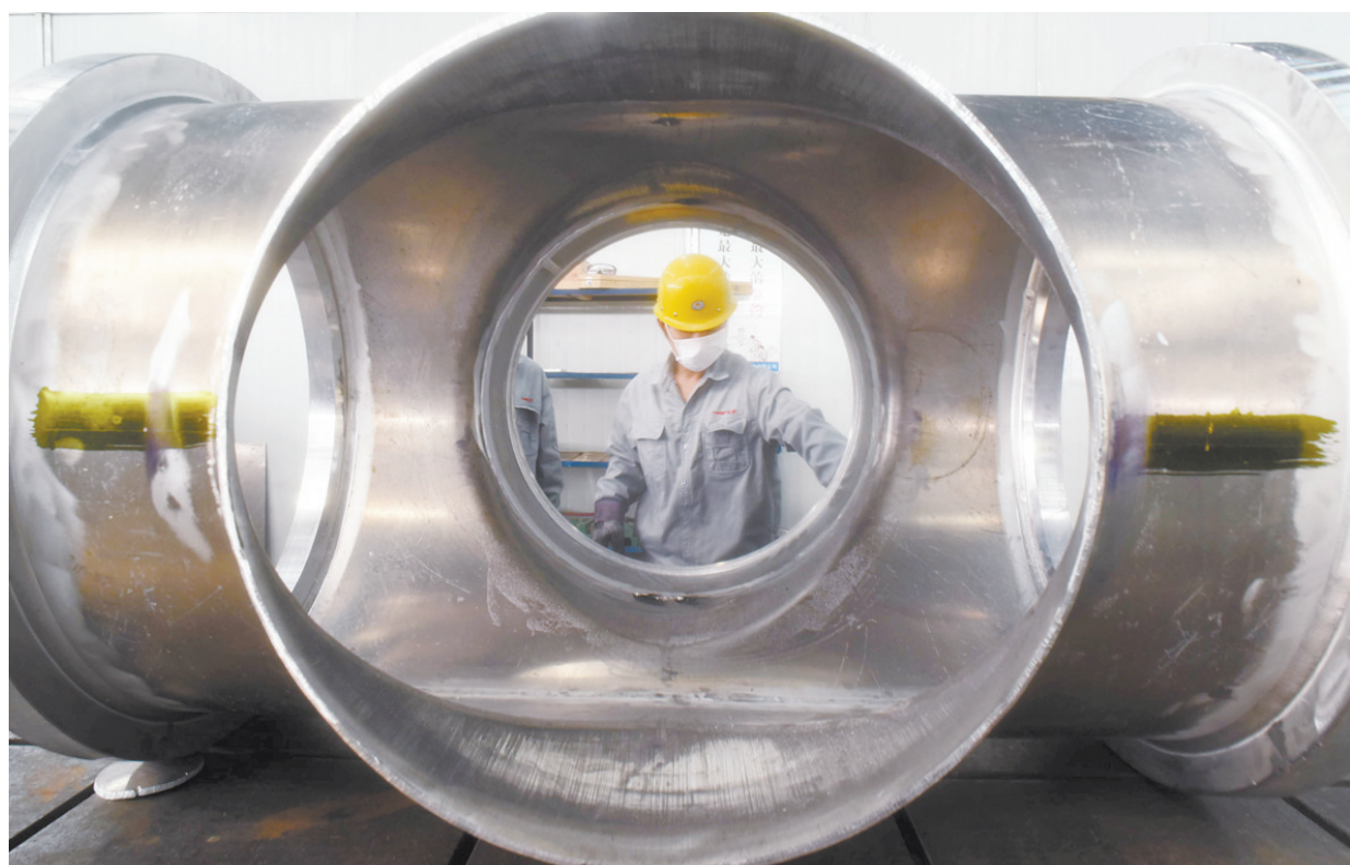
4月24日,工人给铝合金罐体吹管扫尘。位于宝丰县产业集聚区的河南飞宇重工机械制造有限公司GIS核心零部件项目,是专为平高集团生产具备年产3万台GIS高压铝合金罐体的能力。项目全部达产后,可实现年销售收入30亿元。 本报记者 李志勇 摄
