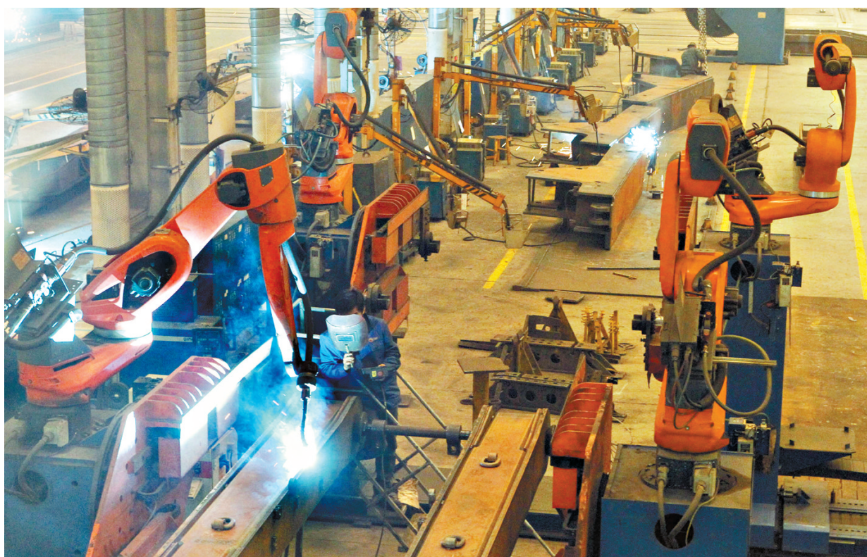
引进焊接机器人
