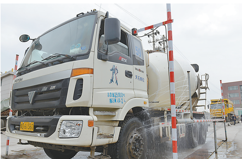
天石商品混凝土有限公司在公司门前设立了车辆冲洗设备。
