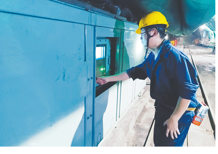
消除设备“堵”点 今年上半年，设备租赁分公司对近年来购置的16套井下局部制冷降温设备分批次、分阶段维保。维保后的井下局部制冷降温设备全部正常运转，喷淋、冷却水系统流量明显增加，冷却水温度达到要求，出风口温度保持在10摄氏度左右。图为8月10日该公司员工对井下局部制冷降温设备进行检修。 本报记者 赵志国 摄
