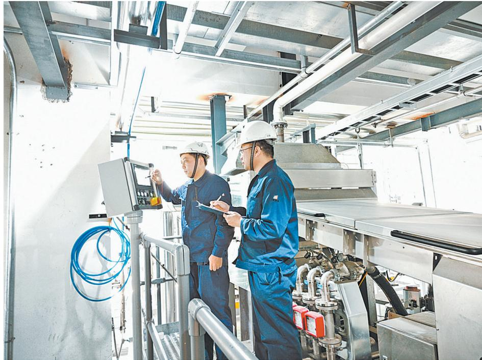
3月21日,在工程塑料公司年产4万吨连续聚合尼龙66切片二期项目现场,塑料四厂聚合工段职工在检查切粒系统溢流水、冷却水、输送水流量。
