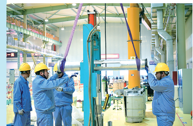
工人在河南省电气装备中试基地车间组装特高压组合电器 本报记者 王尧 摄
